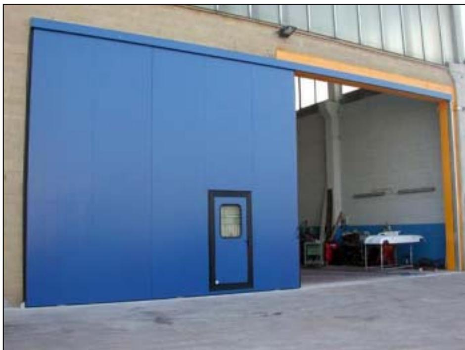
Il portone è costituito da ante dello spessore di 50 mm con rispettivi telai perimetrali interni in profilo d'acciaio zincato spessore 20/10. Le ante sono rivestite integralmente da lamiere ottenute mediante processo di laminazione continua, in acciaio zincato sistema SENDZIMIR, segue la fosfatazione e la stesura di primer dello spessore di 20 Micron.
